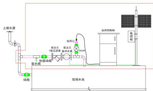
图2 设备管路连接原理示意图
