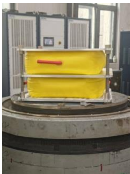
图 8 密闭型气囊缓震系统振动试验示意图
