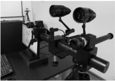
图 5 三维定位数字图像相关测量装置
