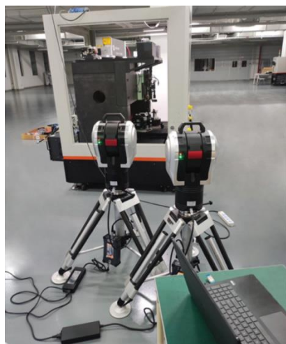
图 2 双激光跟踪仪五轴联动激光空间精度测试
